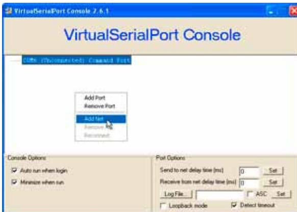
Es erscheint das folgende Konfigurationsfenster, in dem Sie auswählen müssen, dass ein TCP-Server mit dem Port 30000 (Default-Wert) eingerichtet werden soll (selbe Portnummer wie unter 3.) bei der Wandler-Konfiguration.
