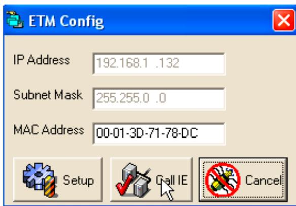
Durch Betätigen dieser Knopfes wird der Standard-Web-Browser Ihres Rechners gestartet und nimmt Verbindung mit diesem Wandler auf. Der Wandler beinhaltet einen kleinen Webserver zur Konfiguration die somit bequem von jedem Rechner im Netz möglich ist. Für das „Login“ ist anfänglich kein Passwort nötig:
